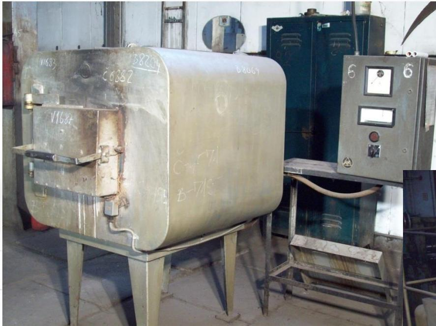
Zagrijavanje materijala pred toplu i vruću plastičnu deformaciju obavlja se u elektro komornim pećima sa gijačima od kantala ili SiC gijačima
